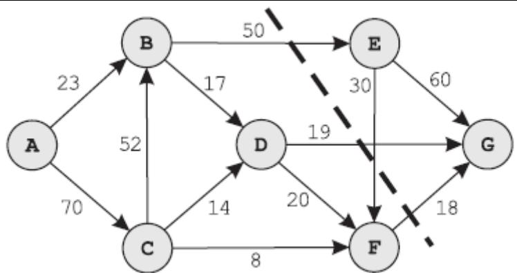
Na slici protoka kroz grafa, isprekidana linija označava *Minimum cut*. U tom slučaju će *Minimum cut* preseći grane BE, DG i FG (grane su usmerene s leve strane isprekidane linije prema desnoj, zato ne brojimo granu EF). Tada se više ne može od čvora A doći do čvora G. Uočite da je suma težina grana BE, DG i FG jednaka  $50+19+18=87$ , a toliko iznosi i *Network flow* (od čvora A do čvora G) za prikazan graf.
